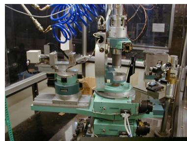
図2. 温度可変 X線 4軸型回折計
